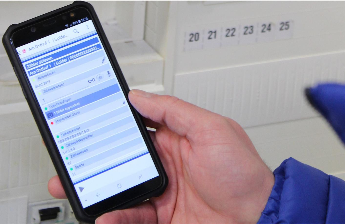
Die Zählerstände werden mit mobilen Endgeräten erfasst.
